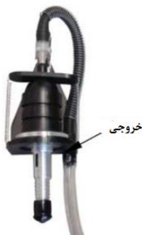
شکل ۴- هم‌گذاری نمونه‌بردار NRD و سیکلون آلومینیومی
