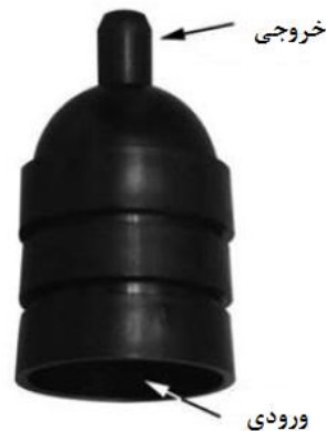
شکل ۱ - محفظه نمونه‌بردار NRD
