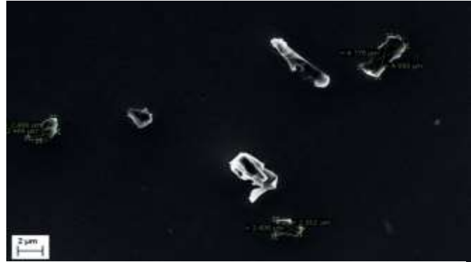
الف - آنالیز درست، ابتدا با گرفتن طول و سپس یافتن عرض به‌صورت عمود منصف
