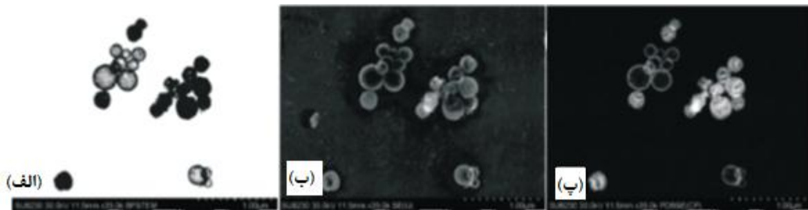
شکل ح-۳ - نانوذرات SiO 2 در سه حالت تصویری الف- میدان روشن، ب- SE و پ- BSE
