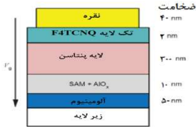
الف- ساختار پنتاسن MIS با عایق AIOx با پوشش فوق نازک SAM
