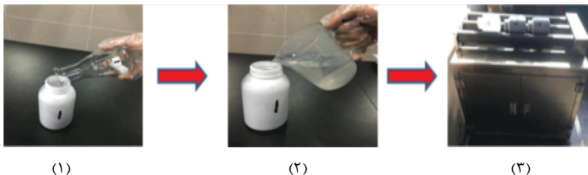
شکل پ-۳- روش اجرایی برای جذب ناخالصی‌های مغناطیسی
