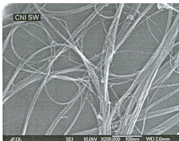
شکل ت-۱ تصویر HRSEM از نمونه نانولوله کربنی تک‌جداره بر روی ویفرسیلیکونی
